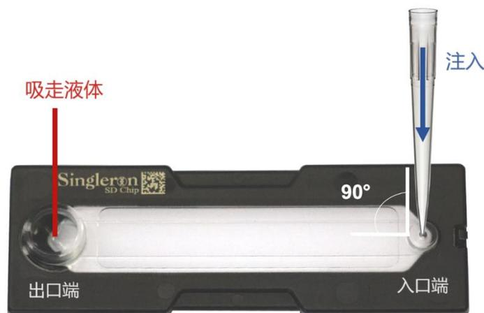
图 2. 微流控芯片液体注入和移除示意图
