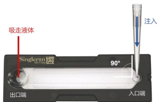
图 2 微流控芯片液体注入和移除示意图
