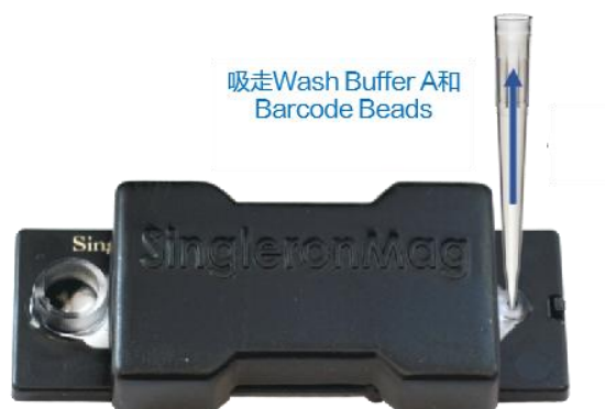
图 3 Barcode Beads 取出示意图
