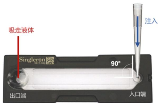
图 2 微流控芯片液体注入和移除示意图
