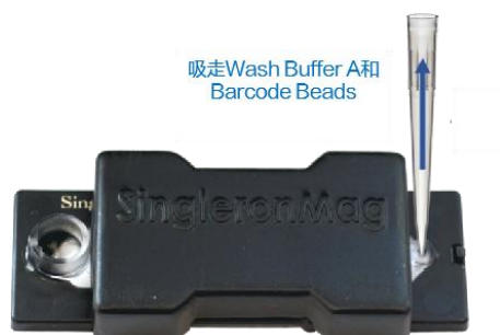
图 3 Barcode Beads 取出示意图
