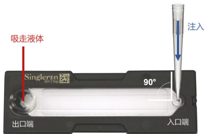
图 2. 微流控芯片液体注入和移除示意图
