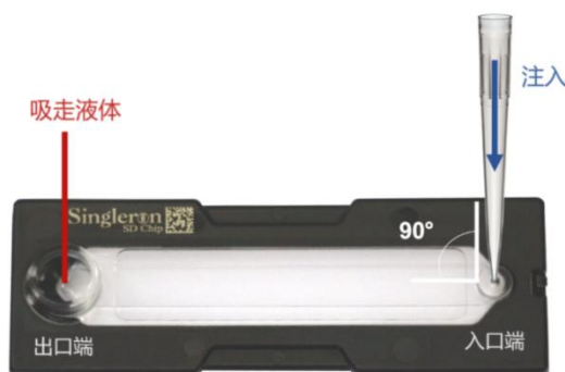
图 1 微流控芯片液体注入和移除示意图
