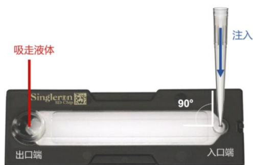
图 2 微流控芯片液体注入和移除示意图
