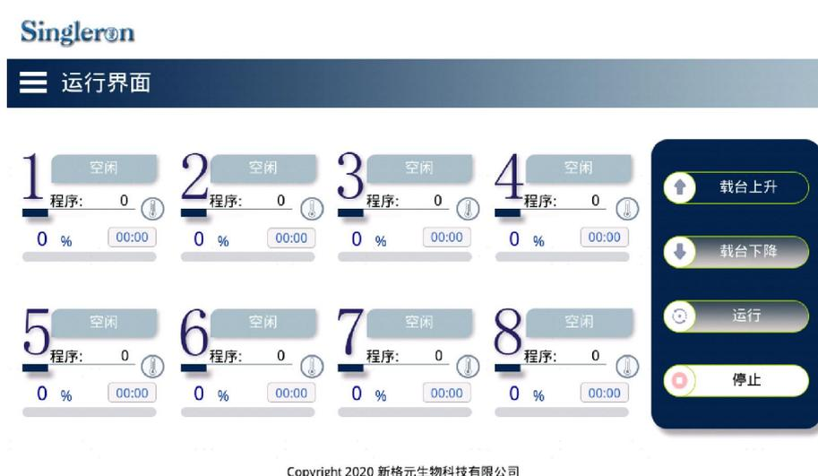
3. 打开仪器仓门，将组装好的 Singleron Python® 组织解离管放置在相应通道内，此时相应位置通道界面显示的“空闲”切换为“样本已放置”，表示解离管完成放置，否则需拿起重新放置；解离管放置完成后，关闭仓门。
