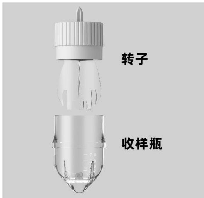
3. 取出收样瓶，用移液器向其中加入 3 mL 完全解冻的 sCellLive®组织解离液，用无菌无酶的镊子夹取事先准备好的组织块，放置于收样瓶内，轻轻转动转子，确保转子能够在收样瓶中轻松转动。
