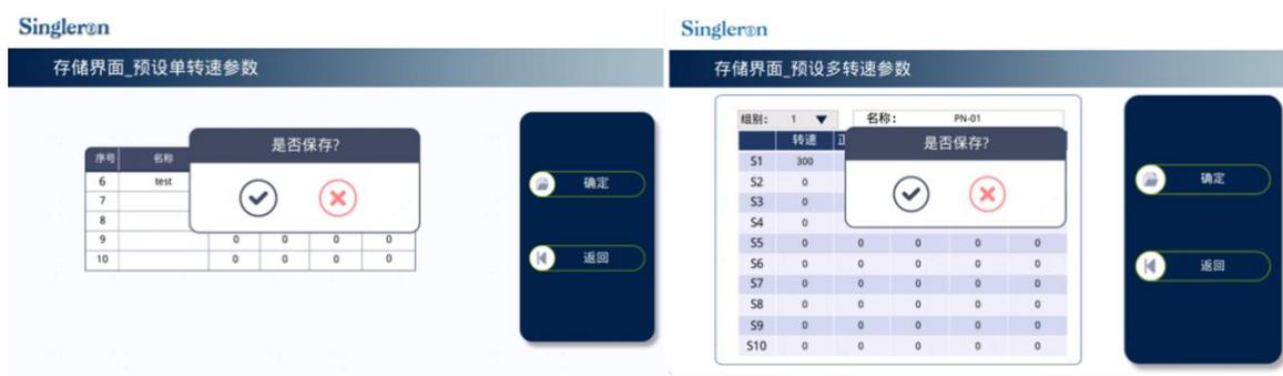
4) 如需修改预设多转速参数，点击“预设多转速参数”并输入密码即可修改预设多段参数；如需修改预设单段参数，点击“预设单转速参数”并输入密码，即可修改预设单转速参数。
