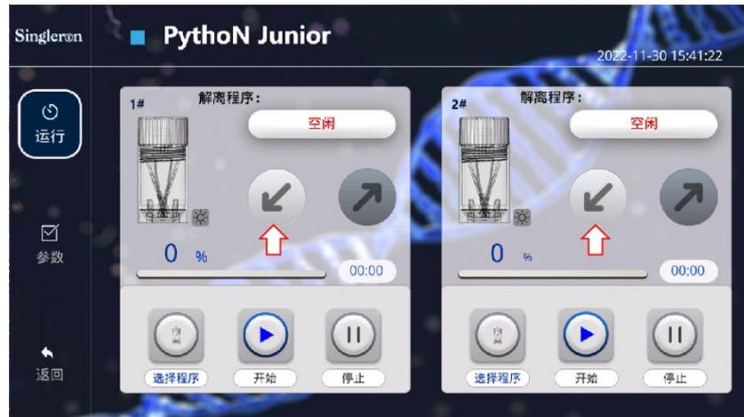
4. 解离管放置完成后，点击对应通道“↗”，仪器自动关闭仓门。
