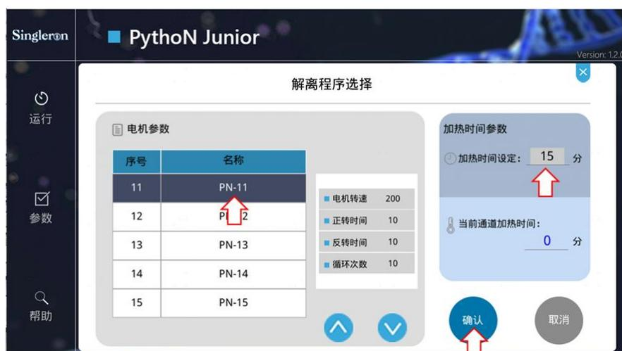
2) 选择运行程序、设置相应的加热时长并点击“确认参数”，加热温度统一为 37°C (其余通道设置方法同上)。
