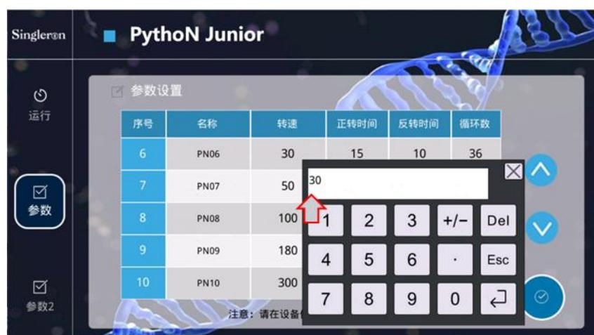
**注意：程序 6-31 为单段程序（预设程序，建议不作更改）；程序 1-5 为多段程序（可自主设置）；程序 32-90 为单段程序（可自主设置）。**
