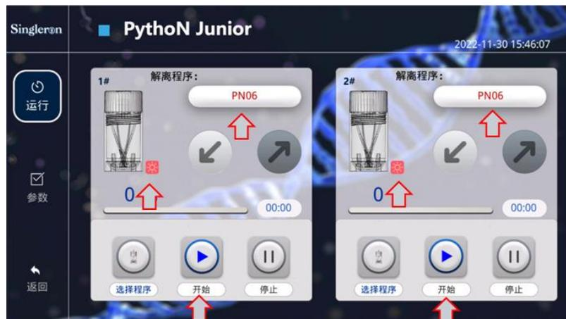
7. 待入仓到位后，“开始”按钮由灰色转至蓝色。点击“开始”，仪器开始工作。运行期间无法操作仪器出入仓，各个通道均显示倒计时，当倒计时为“00:00”，仪器运行结束，并“嘀”声提示，对应通道自动出仓，出仓动作完毕后，取出解离管进行后续实验操作。
