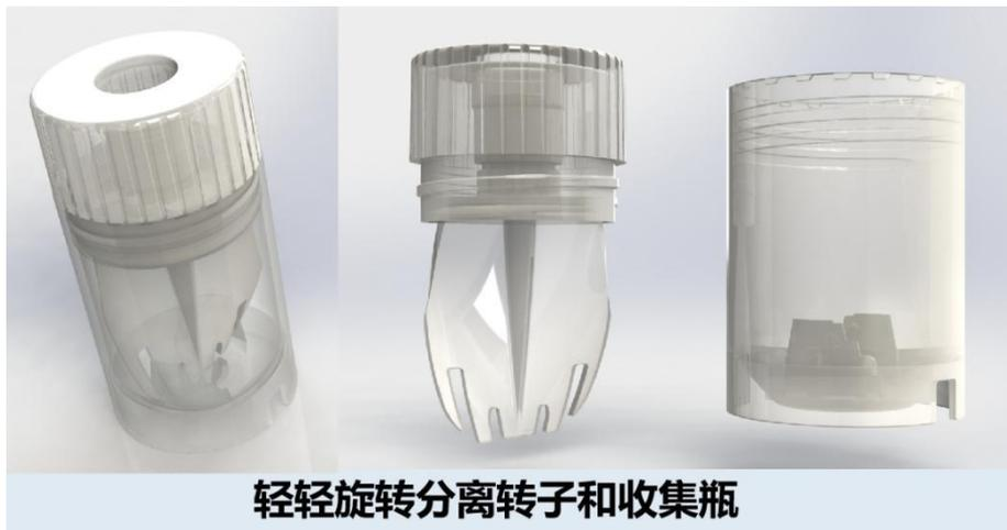
3. 点击屏幕“↙”按钮，仪器出仓。取出收样瓶，用移液器向其中加入 3mL 完全解冻的 sCellLive®组织解离液，用无菌无酶的镊子夹取事先准备好的组织块，放置于收样瓶内，轻轻转动转子，确保转子能够在收样瓶中轻松转动。
