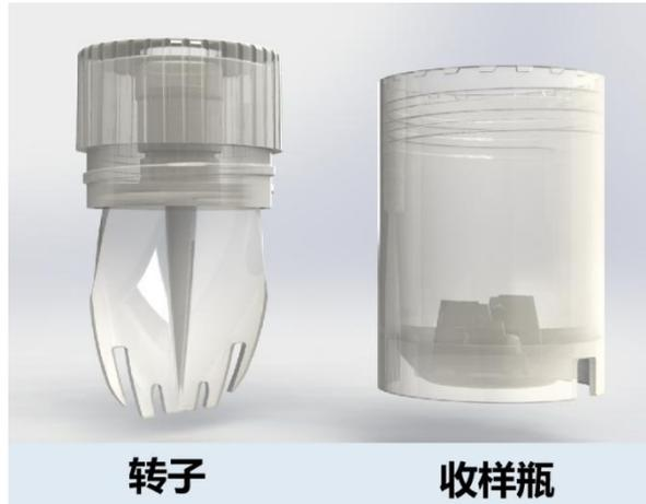
2. 拆开密封袋，取出解离管，轻轻旋转分离转子和收样瓶，如下图所示：
