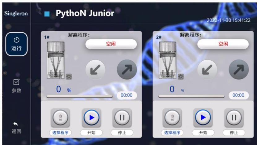
3. 两通道相互独立，点击任一通道“↙”，对应通道自动出仓。将组装好的解离管放置在相应通道内。各个通道底部均设置卡槽，轻轻旋转解离管，确保解离管底部正确卡进通道内（无法大幅度转动），否则须拿起重新放置，如下图所示。
