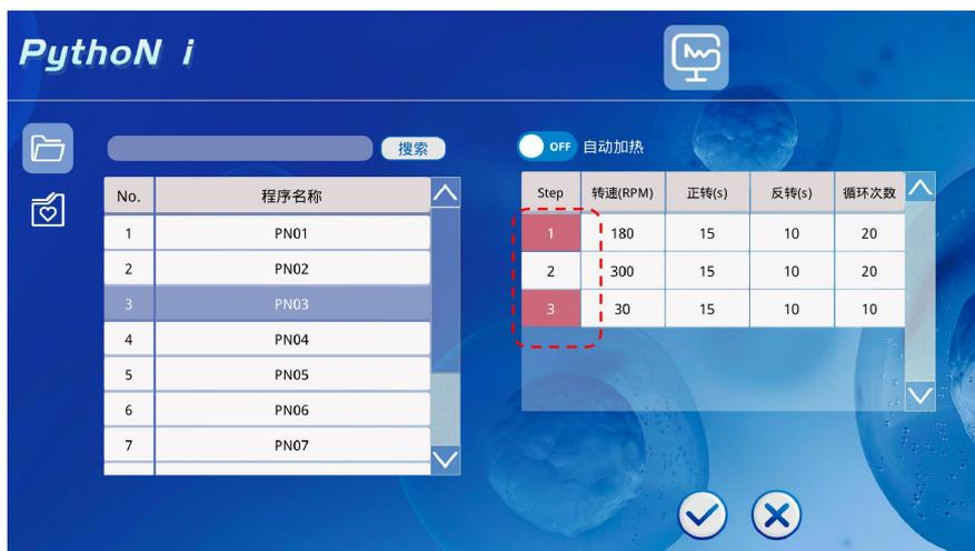
图 21: 启用分段加热的程序选择界面
