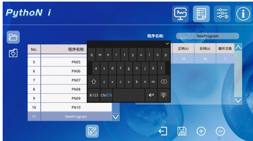
图 30: 程序参数编辑界面
