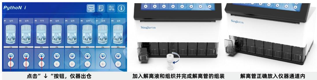
图 6: 解离管的组装和放置
